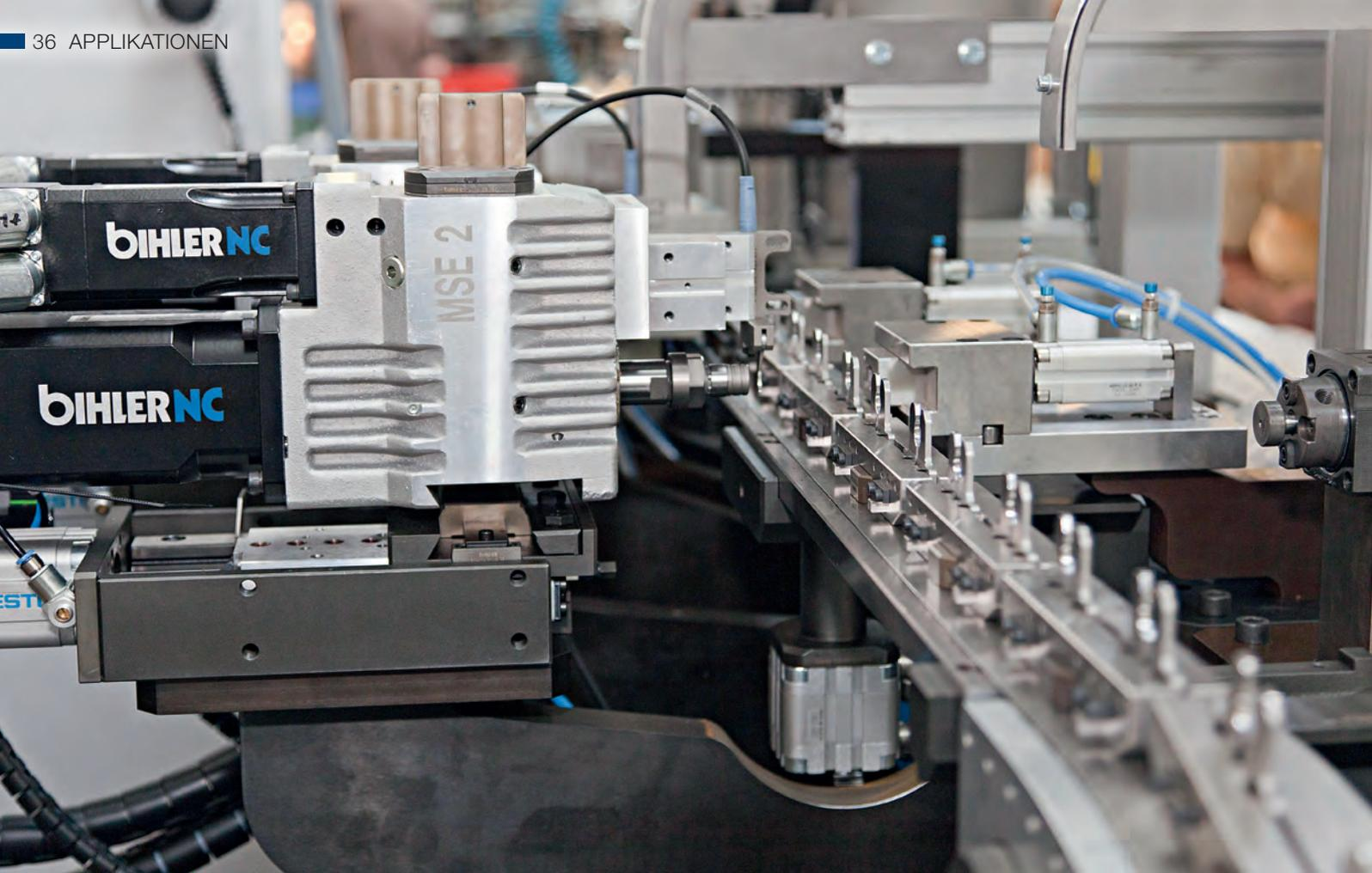
Die neue Bihler BIMERIC BM 1500 fertigt bei Bogner flexibel und dynamisch komplexe Kunststoffstecker.
