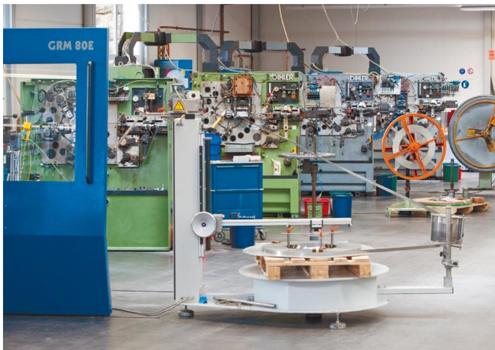
Bei Bogner arbeiten 18 Bihler-Automaten. Sie bieten eine grosse Werkzeuginlänge im kompakten Bauraum. (Bilder: Bihler/Toplak)
